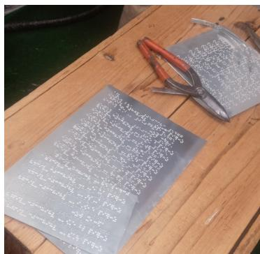
凹面、凸面の亜鉛の版に、紙を挟んで機械で型押しをします。
